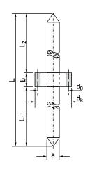
Material 11 S Mn Pb 30 + C | Andere Materialien auf Wunsch. Spezialverzahnung linkssteigend Achsdurchmesser in h6 Passend zu Schrägzahn-Zahnstangen Seite 32
