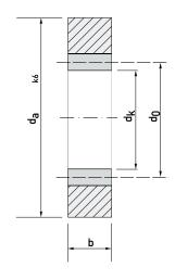
Material Bronze Schleuderguss EN CC 483 K Außendurchmessser in k6 Passend zu Geradzahnstirnrädern Seiten 15 bis 26
