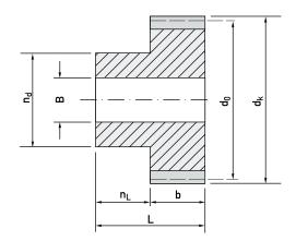
Zahnbreite 2 mm Nabenlänge 6 mm Gesamtlänge 8 mm Material ETG 100/88 Bohrung in H7
