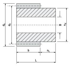
Schnecken | ein- oder zweigängig rechts Material ETG 100 Bohrung in H7 Passend zu Schneckenrädern Seite 11
