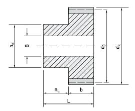
Zahnbreite 10 mm Nabenlänge 8 mm Gesamtlänge 18 mm Material ETG 100/88 bzw. Delrin (POM) Bohrung in H7
