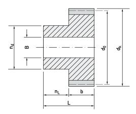
Zahnbreite 5 mm Nabenlänge 4 mm Gesamtlänge 9 mm Material ETG 100/88 bzw. Delrin (POM) Bohrung in H7
