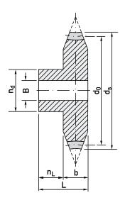
Schneckenräder | ein- oder zweigängig rechts Material EN CC 483 K Bohrung in H7 Passend zu Schnecken Seite 9.
