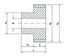
Zahnbreite 7 mm Nabenlänge 6 mm Gesamtlänge 13 mm Material ETG 100/88 bzw. Delrin (POM) Bohrung in H7
