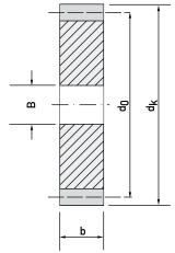
Modul 0,5 | Zahnbreite 2 mm Modul 0,7 | Zahnbreite 3 mm Modul 1,0 | Zahnbreite 4 mm
