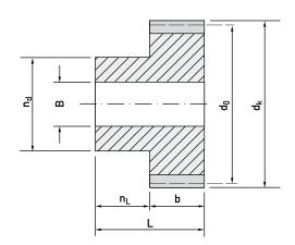
Zahnbreite 17 mm Nabenlänge 13 mm Gesamtlänge 30 mm Material ETG 100/88 bzw. POM Bohrung in H7
